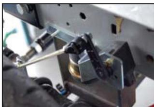
(Блок управления пневмоподвеской), который автоматически контролирует и регулирует высоту транспортного средства. Этот постоянный мониторинг и регулировка уровня (независимо от загрузки, продольного и бокового смещения и независимо относительно центра тяжести), автоматически способствует безопасному поведению транспортного средства на дороге и лучшему комфорту. Возможна максимальная загрузка транспортного средства.
